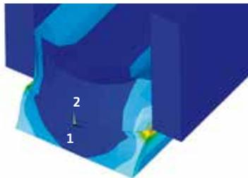
Finite-Element-Berechnungen zeigen die kritischen Punkte in der Konstruktion auf. Durch richtige Auswahl des Klebstoffes und Fügegeometrie wird die Fensterkonstruktion optimiert.
