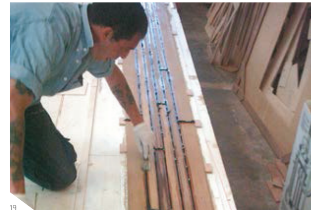
Abb. 18: Deck mit einer Industriebandschleifmaschine abschleifen
