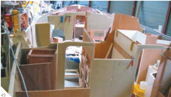
Abb. 49: Leichtbauplatten werden an einen offenen Schiffsrumpf angebracht
