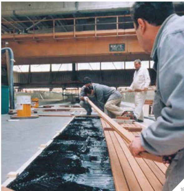
Abb. 16: Aufbringen des Decks
