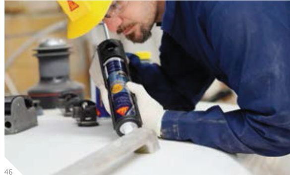
Abb. 46: Abdichten der Flanken einer Scheuerleiste aus Chrom
