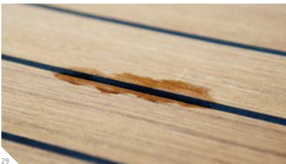
Abb. 29: Beschädigtes Teakdeck durch Wassereinbruch
