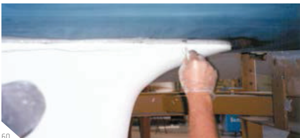
Abb. 60: Die Verbindungsfuge wird fertiggestellt
