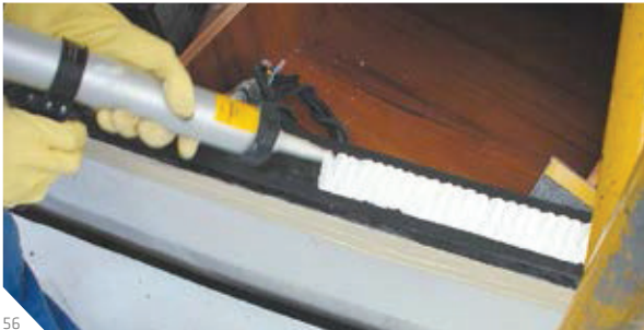
Abb. 55: Sikaflex®-292i wird dickschichtig auf die Verbindungsfläche aufgetragen: Am Bug ... Abb. 56: ... und entlang der Seiten
