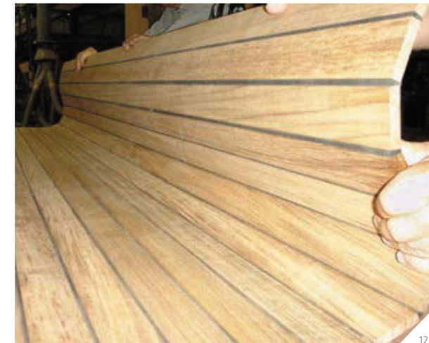
Abb. 12: Vorgefertigtes Teakdeck aus Stabdeckleisten mit beachtlicher Festigkeit und Elastizität
