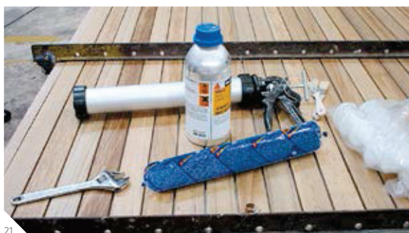
Abb. 21: Stabdeck zur Aushärtung eingespannt
