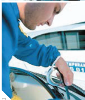
Abb. 63: Beispiele von mit Sikaflex*-295 UV geklebtem Kunststoffglas in Verbindung mit Sika® UV Shielding Tape
