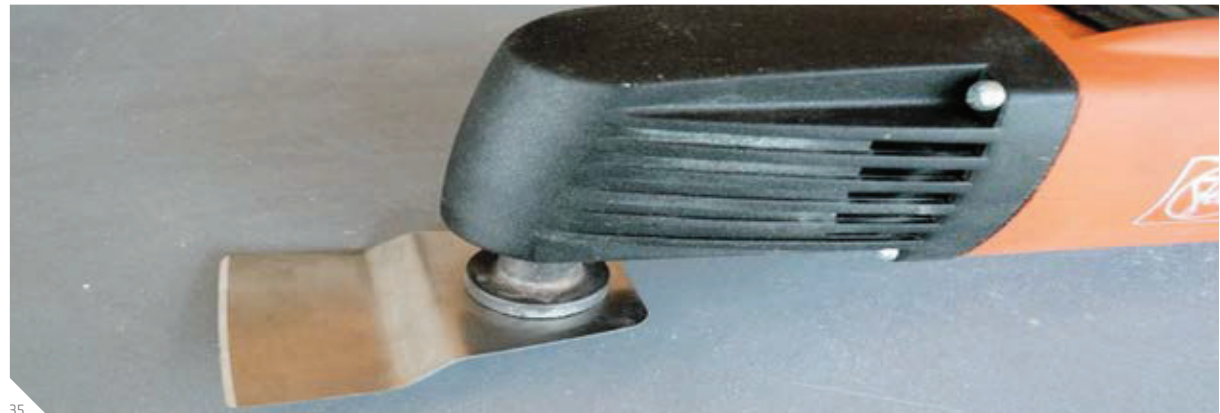
Abb. 34: Zuerst altes Klebebett mit einem Schaber entfernen
