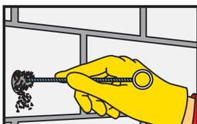
Das Bohrloch muss dann wieder mit einer speziellen Stahlbürste (Pinsel mindestens 2 mal) gründlich gereinigt werden. Der Durchmesser der Bürste muss größer sein als der Durchmesser der Bohrung.
