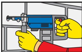
Bohren des Loches mit einer elektrischen Bohrmaschine auf den Durchmesser und die erforderliche Tiefe. Der Bohrl Lochdurchmesser muss der Ankergröße entsprechen.
