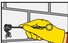
Das Bohrloch muss mit einer speziellen Stahlbürste (Pinsel mindestens 2 mal) gründlich gereinigt werden. Der Durchmesser der Bürste muss größer sein als der Durchmesser der Bohrung.
