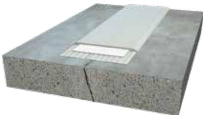
Bei Arbeitsfugen oder statischen Rissen wird das Sikadur-Combiflex® SG Band komplett mit Sikadur® Epoxidharzklebstoff überschichtet. Der Klebstoff kann, je nach Anforderung, geglättet, abgesandet oder beschichtet werden. Risse > 1 mm sind wie Bewegungsfugen auszubilden.
