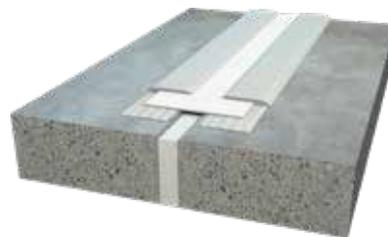
Bei Bewegungsfugen oder größeren Rissen wird das Sikadur-Combiflex® SG Band in der Dehnungszone ohne Epoxidharzklebstoff eingebaut. Die unverklebte Bandzone ist für die Bewegungsaufnahme maßgebend. Bei sehr hohen Bewegungen ist das Band schlaufenförmig zu verlegen.
