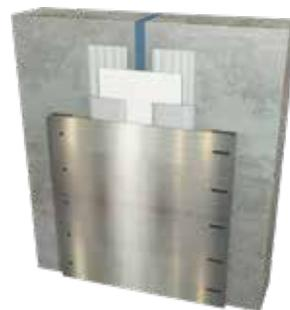
Bei Fugen, die negativem Wasserdruck über 0,5 bar ausgesetzt sind, muss das Sikadur-Combiflex® SG Band einseitig durch ein Stahlprofil gesichert werden.
