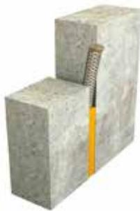
Brandbeständige Hinterfüllschnur mit herkömmlichem Fugendichtstoff
