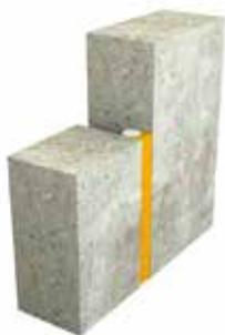
PE-Hinterfüllschnur mit brandbeständigem Fugendichtstoff
