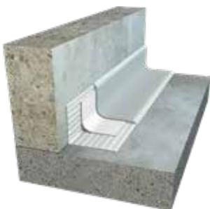
Es ist empfehlenswert, die Boden-Wand-Anschlüsse innenseitig wie Hohlkehlen auszuführen. Der Sikadur® Epoxidharzklebstoff unter dem Band kann entsprechend ausgebildet werden. Beim Einbau als Negativabdichtung ist der Wasserdruck auf 0,5 bar limitiert.
