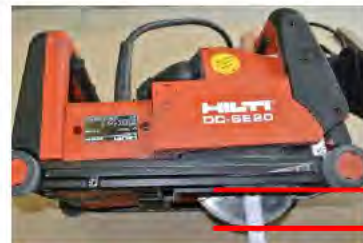
Schnitttiefe: Das Schlitzgerät muss auf eine Tiefe von 2,0 cm justiert werden.
