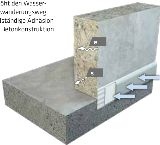
Bild 1: Durch Einsatz des Sikadur-Combiflex® SG Systems wird der Wasserumwanderungsweg erheblich höher als die Wassereindringtiefe
