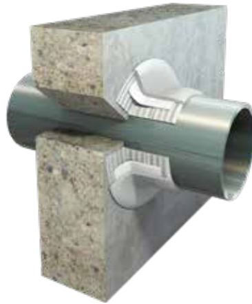
Bild 9: Rohrdurchdringungen können mit dem Sikadur® Epoxidharzklebstoff ausgeführt werden. Je nach Material des Rohrs ist ein entsprechender Primer oder ein angepasster Klebstoff ggf. mit zusätzlicher Rohrschelle zu verwenden.
