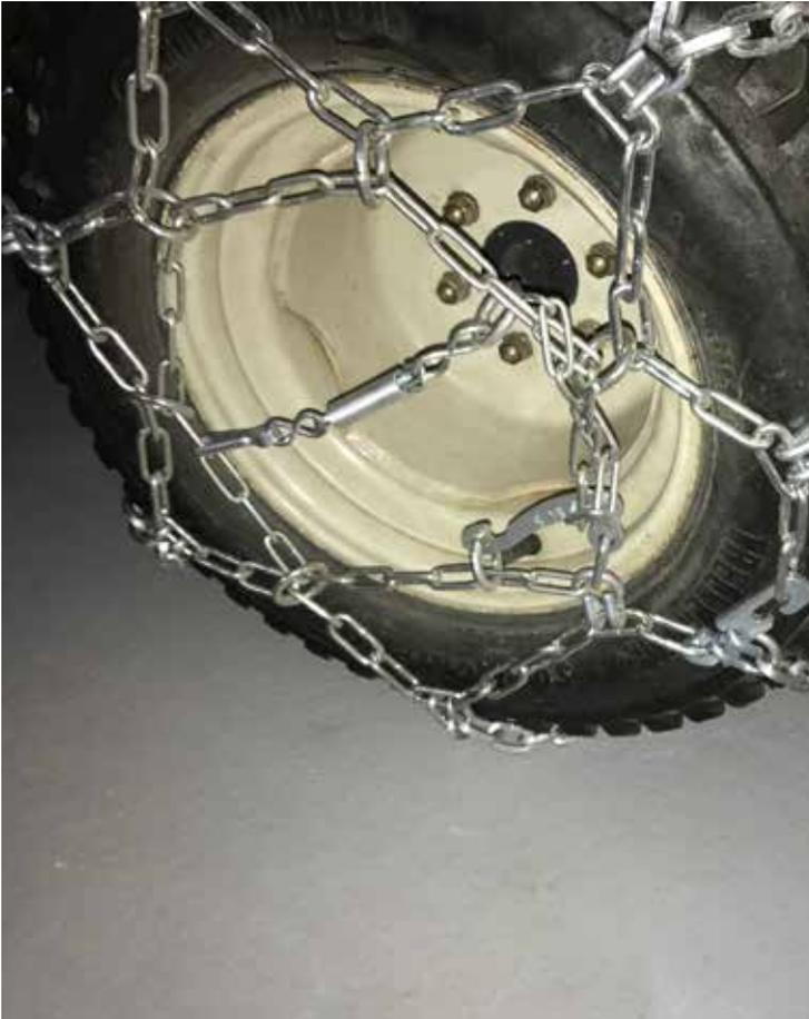
Bild 2: Hohe Druckbelastung durch einzelne Kettenglieder
