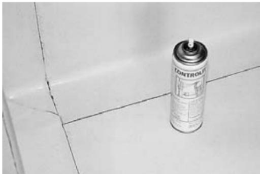
Besprühen Sie den ganzen Nahtbereich mit einer blasenbildenden Flüssigkeit, z.B. Seifenwasser oder Lecksuchspray.
