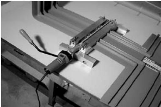
Das Heischwert auf ca. 420 °C vorheizen und zwischen die beiden Fugenbandenden positionieren. Die **Sika® Fugenband Schablone** schlieen und mit leichten Druck zusammenpressen, bis rundum eine ca. 1 mm dicke Schweibraupe sichtbar wird.
