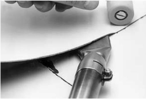
Zur Verschweißung des abgeschrägten T-Stoßes wird das Handschweißgerät verwendet.
