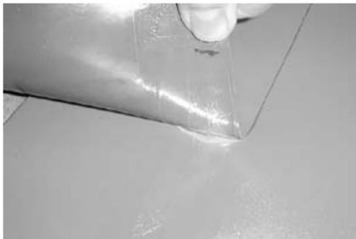
**Schältest längs zur Naht
