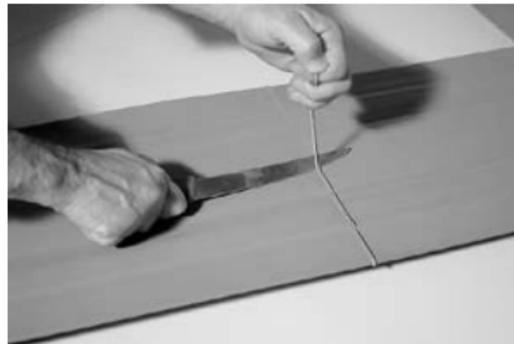
Mittels Messer oder Kantenschneider die Schweibraupe von der zu verschweienden Seite entfernen.
