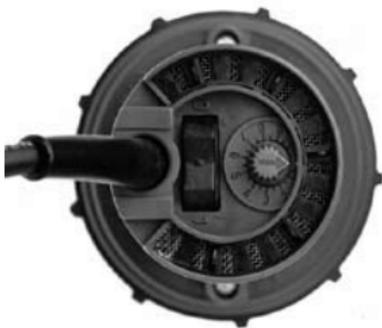
Der Luftregelschieber muss geöffnet und die Luftdurchlassöffnungen müssen staubfrei sein. Staub- und Schmutzablagerungen werden am besten mit einem Pinsel oder mit Pressluft, von der Düse her, entfernt.
