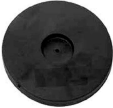
Punktbefestigung mit **SikaPlan® WP** (PVC-P) oder **SikaPlan® WT** (FPO) Rondellen: die Rondelle wird mit einer Nagelpistole befestigt (z.B. Hilti DX).
