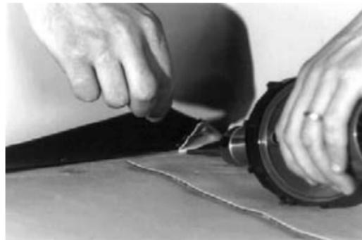
Die in sich zusammengeschnittene Tasche mit der aufgeschweißten Überlappung verschweißen.
