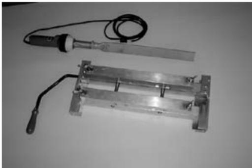
Verschweißen von **Sika® Fugenbändern** mittels Sika® Fugenband Schablone und Leister PID mit Heizschwert.
