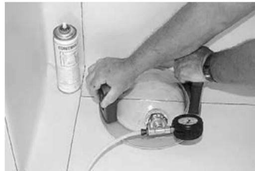
Zur Prüfung längerer Nähte bewegen Sie die Vakuumglocke entlang der Naht. Stellen Sie sicher, dass alle zu prüfenden Nahtbereiche vollständig abgedeckt sind.
