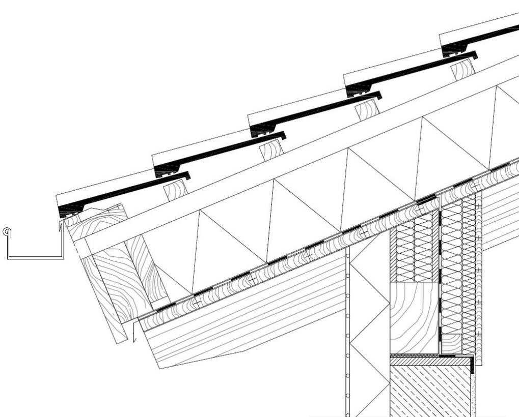
**Schemaskizze Ausparrendämmung | Traufe
