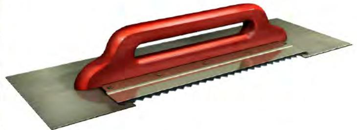
Um Lufteinschlüsse zu vermeiden ist der Systemkleber (Sikadur®-31 CF Normal oder Sikadur®-30 CF Normal) mittels Zahntraufel auf die Fugenprofile aufzutragen.
