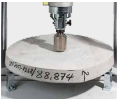
Prüfung runder Platten: ASTM C1550
