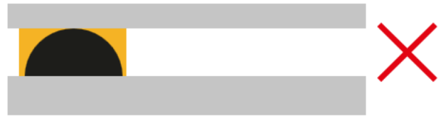
Abbildung 8 Abstandshalter zu groß für die Breite der Klebefuge
