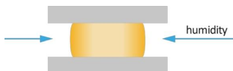
Abbildung 1 Prinzip der Aushärtung bei Luftfeuchtigkeit
