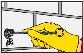
Das Bohrloch muss danach wieder mit einer speziellen Stahlbürste (Pinsel mindestens 2 mal) gründlich gereinigt werden. Der Durchmesser der Bürste muss größer sein als der Durchmesser der Bohrung.
