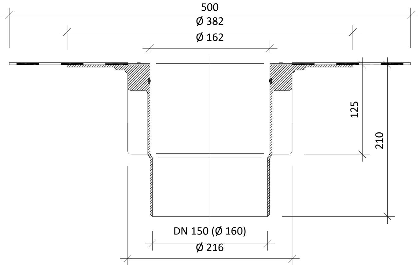
Rohbaumaße für Essmann Gully Classic / Gully Schraubflansch / Gully PVC
