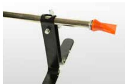
6. Befestigen Sie das Distanzstück am Ende der Schaumpistole. Dadurch wird der richtige Abstand zwischen der Düse und dem Untergrund sichergestellt.
