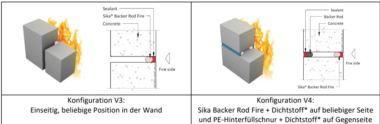
\*Sika Backer Rod Fire kann mit jedem Sika Dichtstoff kombiniert werden
