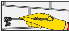
Das Bohrloch muss gründlich mittels Drahtbürste gereinigt werden. (mindestens 2 Mal). Der Bürstendurchmesser muss grösser als der Durchmesser des Bohrlochs sein.
