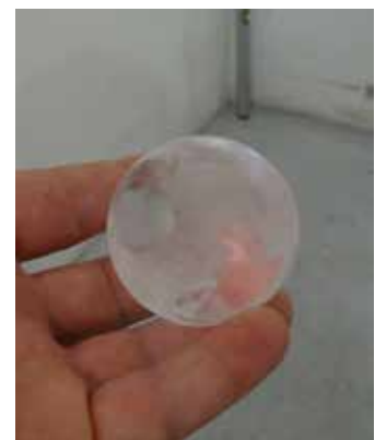
Hagelprüfung, Kugelgröße 50 mm
