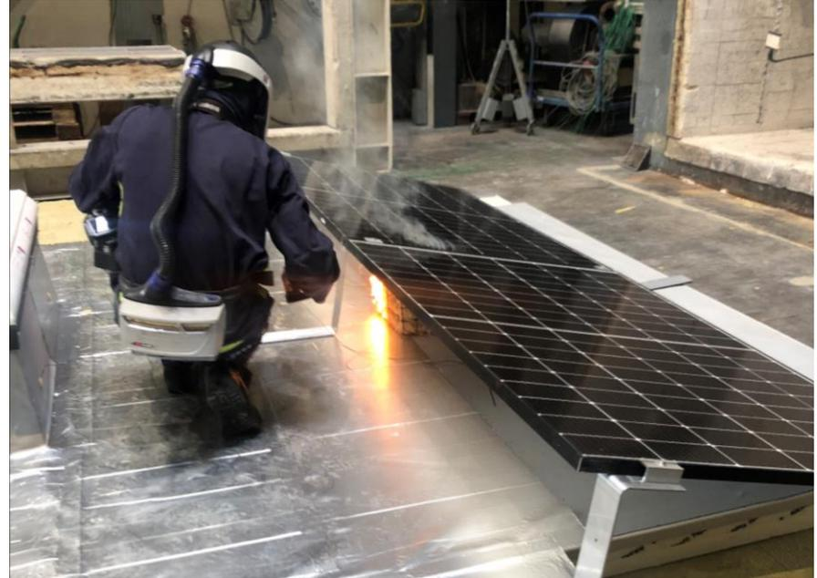
Als Brandquelle wird ein Gitterkorb mit Holzwolle mittig unter die PV-Module gestellt.
