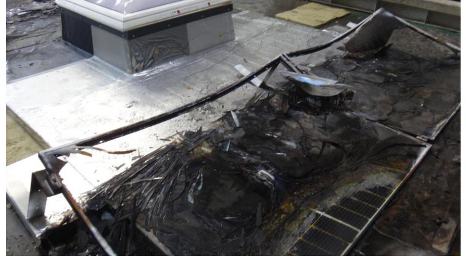
Komplette Zerstörung der PV-Anlage, während SikaRoof® Fire Screen unverändert bleibt! Außergewöhnlich auch die Wirkung am Hochzug der Lichtkuppel.
