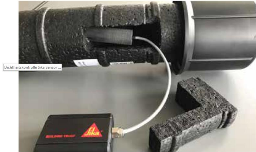
Sensor wird im Dämmkern eingesteckt und verschlossen.
