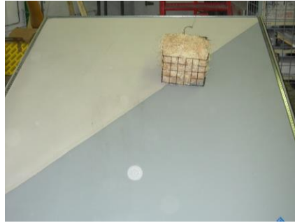
Prüfkörper, 15° Neigung Brandkörper: 30x30x30cm, 600g Holzwolle
