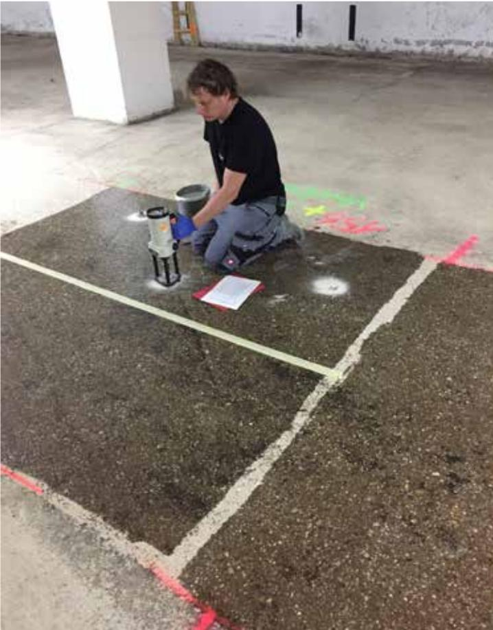
Bild 2: Prüfung der Haftzugfestigkeit auf einer Musterfläche im Zuge der laufenden Fremdüberwachung
