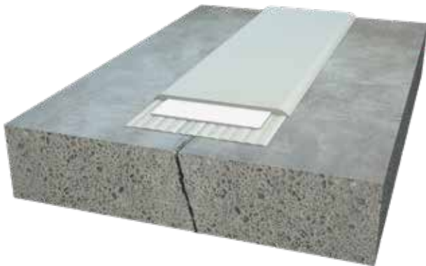
Bild 4: Bei Arbeitsfugen oder statischen Risse wird das Sikadur-Combiflex® SG Band komplett mit Sikadur® Epoxidharzklebstoff überschichtet. Der Klebstoff kann, je nach Anforderung, geglättet, abgesandet oder beschichtet werden. Risse > 1 mm sind wie Bewegungsfugen auszubilden.
