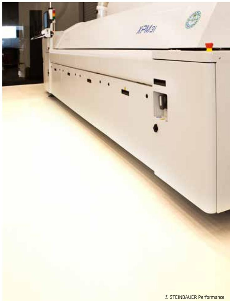
Bild 1 - Elektrostatisch ableitfähige Beschichtung im Produktionsbereich
