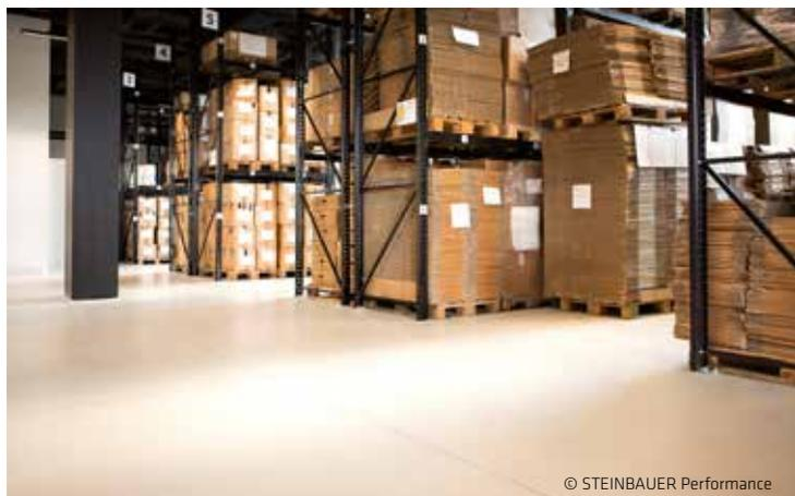
Bild 3 - Belastbarer Industriefußboden mit EP-Beschichtung
