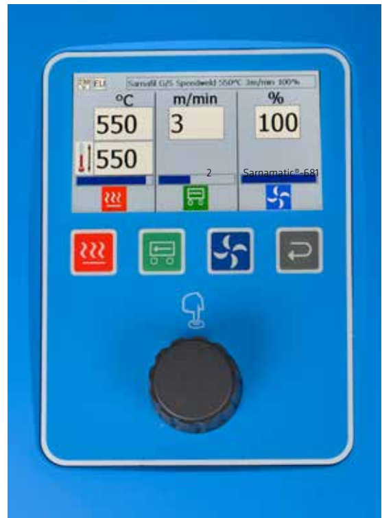
4.3" TFT Farbdisplay, sehr gute Lesbarkeit auch bei heller Umgebung.
