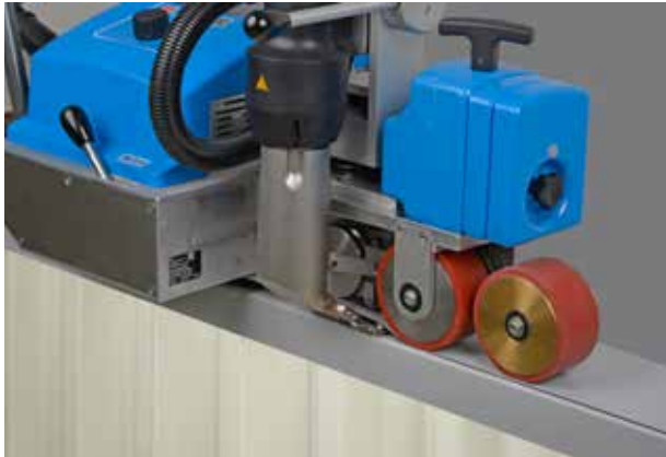
Schweißen auf einer nur 15 cm breiten Fläche, z.B. Attika möglich, dank verstellbarer Rollenführung.
